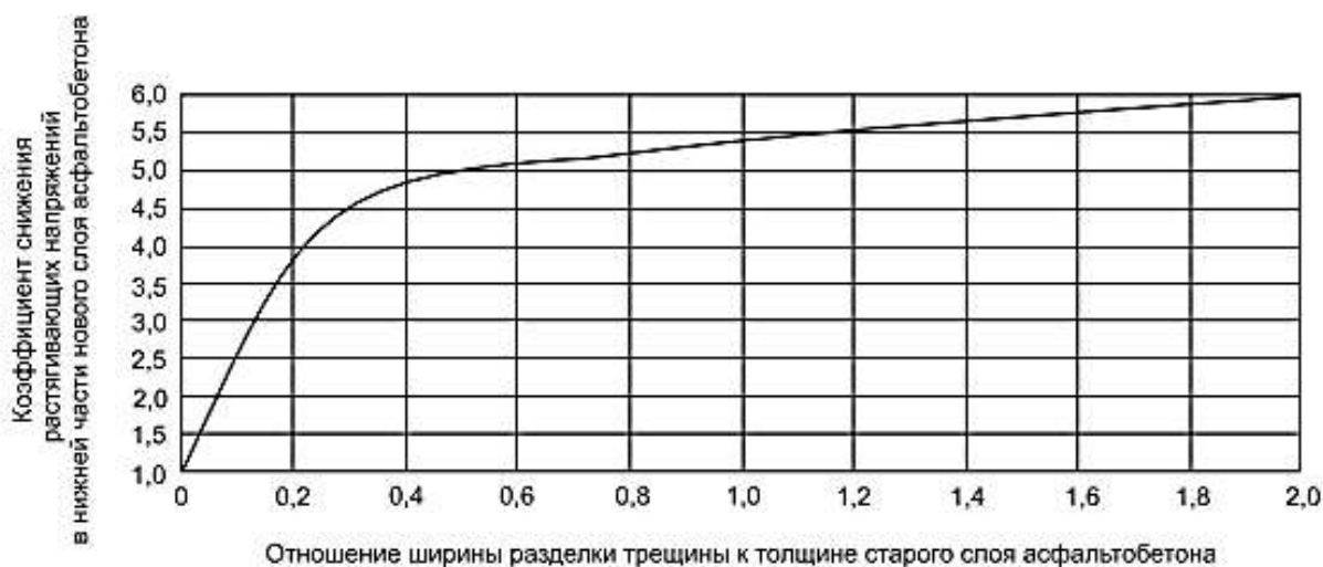
Рисунок Е.2 – Зависимость ширины разделки трещины от коэффициента снижения растягивающих напряжений
