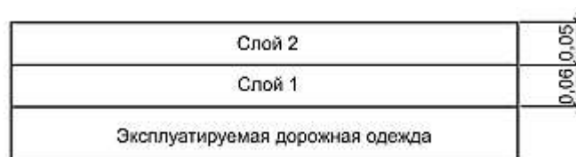
Рисунок Ж.5 – Общий вид ремонтируемой дорожной одежды
